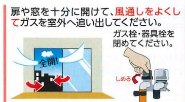
ガス警報器が作動したり、ガス臭いと感じたときにはすぐにガス事業者へ連絡してください。点検を受けるまではガスを使わないでください。
